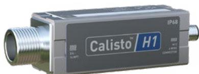
**CALISTO® H1** : Inclut le capteur d'hydrogène électronique leader du secteur, dans un boîtier robuste et pourtant compact. Il prélève en continu l'huile des transformateurs pour détecter les pics de concentration d'hydrogène qui sont souvent le signe d'une défaillance électrique.
