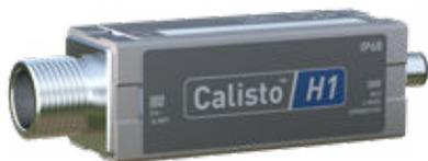
**CALISTO® H1:** 在坚固而紧凑的外壳中包含业界先进的固态氢传感器技术。它不断对变压器中的油进行取样，以检测氢含量的峰值，而氢含量增高往往表示可能发生电气故障了。
