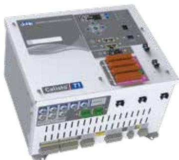
**CALISTO® T1:** 以经济高效的方式将套管、局部放电和输入/输出模块的功能集于一个可配置的监测装置中。它通过内置服务器提供简洁的用户界面，并管理用户访问权限、警报设置、警报管理和数据可视化，将来自 Doble 和第三方设备的数据汇集在一起。标准通信协议包括 Modbus、DNP3 以及可选的 IEC 61850，允许数据在 Calisto T1 和 SCADA 等其他应用程序之间传输。
