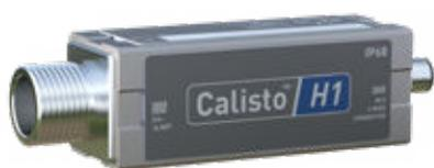
**CALISTO® H1:** contém a melhor tecnologia do setor de sensor de hidrogênio em estado sólido em um pacote robusto, mas ainda compacto. Ele pega amostras do óleo nos transformadores continuamente para detectar picos nos níveis de hidrogênio, que costumam indicar um erro elétrico.
